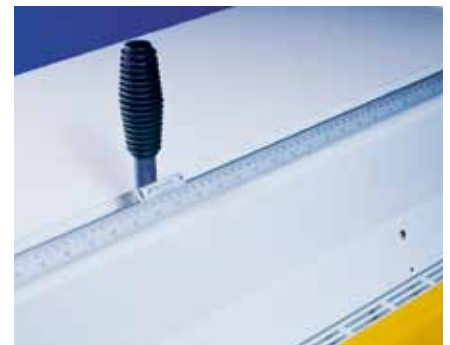
Der Handanschlag (nur für SMARTcut) lässt sich von vorne schnell und präzise positionieren.
