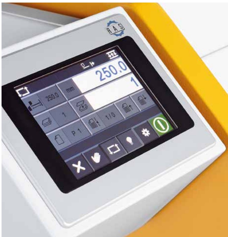
Steuerung mit Touch Screen Monitor.
